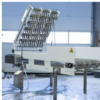
Figur 83. Stunner åbnet for vedligehold – Optimar
