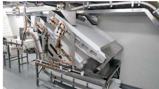
Figur 110. Bifangstseparator ombord på VA72K Sjøvik
