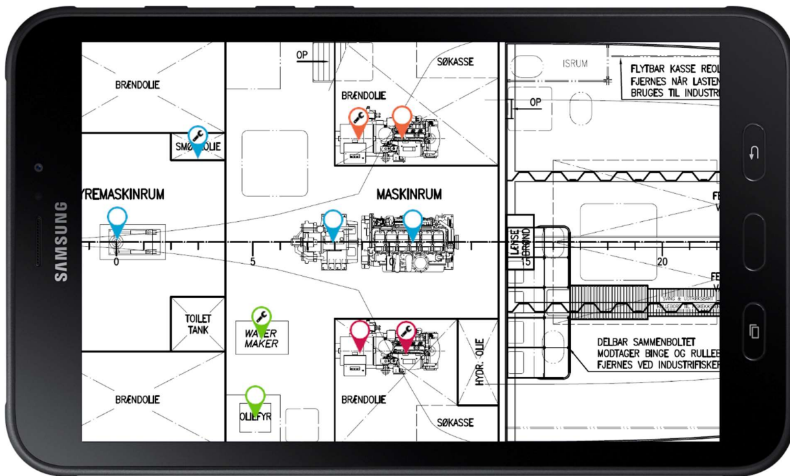
Figur 134. Illustration fra SafeEx vedligeholdssystemet. ©2019 SafeEx ApS (Illustration er på Engelsk, men kan vælges på Dansk også)
